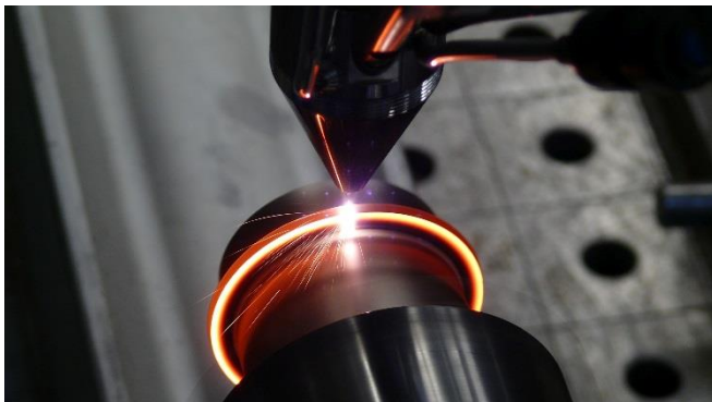
Bild 2: Extremes Hochgeschwindigkeits-Laserauftragschweißen (EHLA): Flexibel beschichten, reparieren oder additiv fertigen - mit einer Systemtechnik. © Fraunhofer ILT, Aachen.
