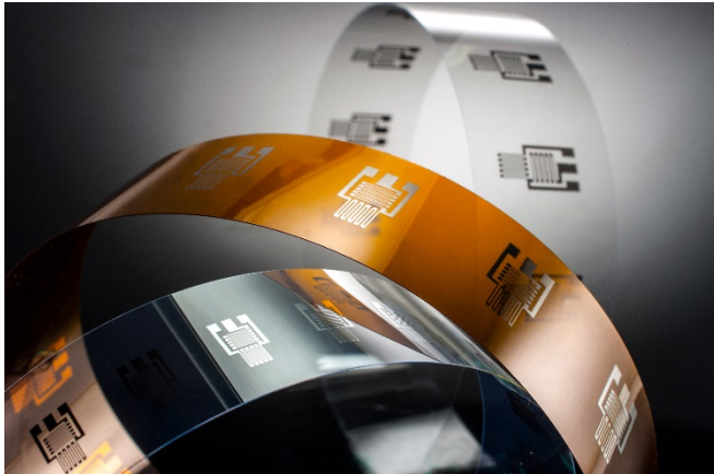
Bild 1: Direktdruck: Das Fraunhofer ILT führt einen Dehnungsmessensor vor, der sich dank der Kombination von Druck- und Lasertechnik direkt und automatisierbar auf dem Bauteil aufbringen lässt. © Fraunhofer ILT, Aachen.
