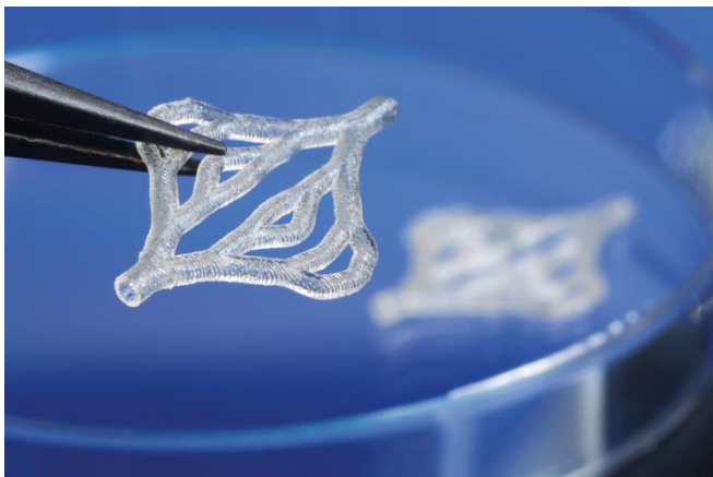
Bild 1: Ziel ist es, mit der Kombi- Maschine verzweigte Mikroröhren ebenso wie komplette Mikrofluidiksysteme herzustellen. © Fraunhofer ILT, Aachen.
