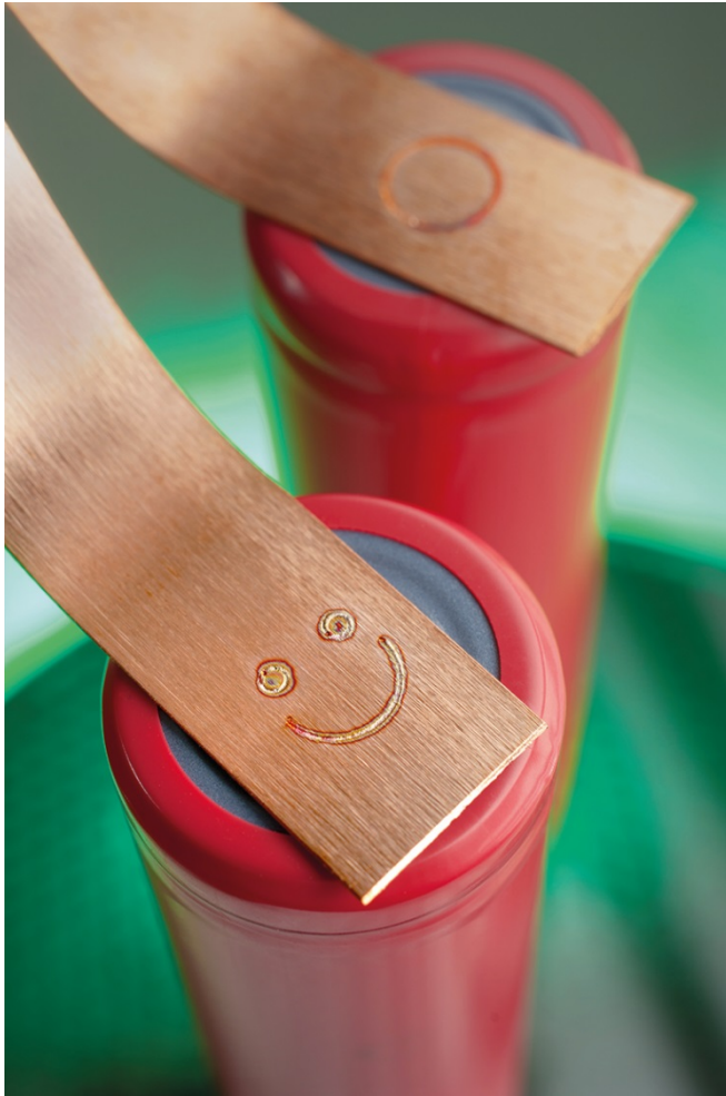
Bild 1: Das Laser-Based Tape- Automated Bonding (LaserTAB) zum Schweißen von Batteriezellen. © Fraunhofer ILT, Aachen.
