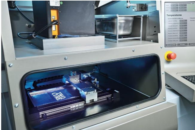
Bild 3: Gekühlte »TwoCure«- Prozesskammer mit Dosiereinheit und UV- Lichtquelle (Auflösung: 50 µm, 2580x1650 Pixel). © Fraunhofer ILT, Aachen.
