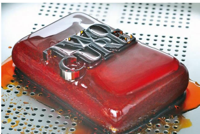
Bild 2: Durch Schmelzen bei Raumtemperatur lösen sich die additiv gefertigten Kunststoffbauteile aus den gefrorenen Blöcken heraus. © Fraunhofer ILT, Aachen.
