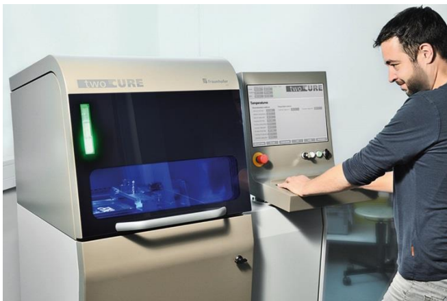
Bild 1: Auf der formnext präsentiert das Fraunhofer ILT den Prototypen der »TwoCure«-Anlage für den harzbasierten, stützf freien 3D-Druck von Kunststoffbauteilen. © Fraunhofer ILT, Aachen.
