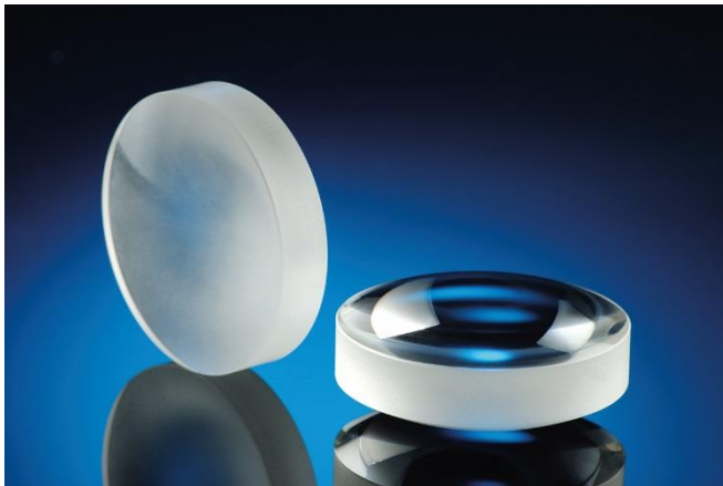
Bild 1: Laserpolierte Sphäre aus BK7. © Fraunhofer ILT, Aachen.
