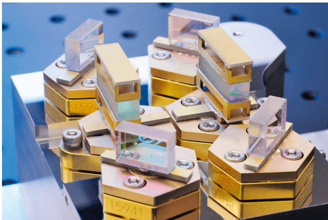
Bild2: Optisch parametrischer Oszillator (OPO) für das MERLIN-LIDAR-System, basierend auf dem neuen Future Laser System (FULAS) des Fraunhofer ILT. © Fraunhofer ILT, Aachen.
