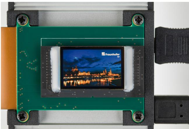
**24 mm 120 Hz WUXGA OLED Microdisplay**
