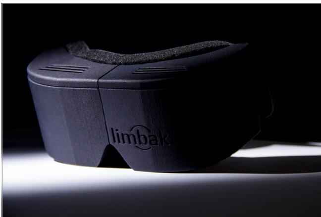
**Prototyp einer VR-Brille mit 4 hochauflösenden OLED-Mikrodisplays**
