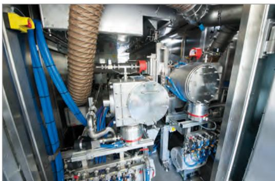
**Innenansicht der neuen E-VITA-Anlage mit Blick auf die Elektronenquellen des Fraunhofer FEP**
