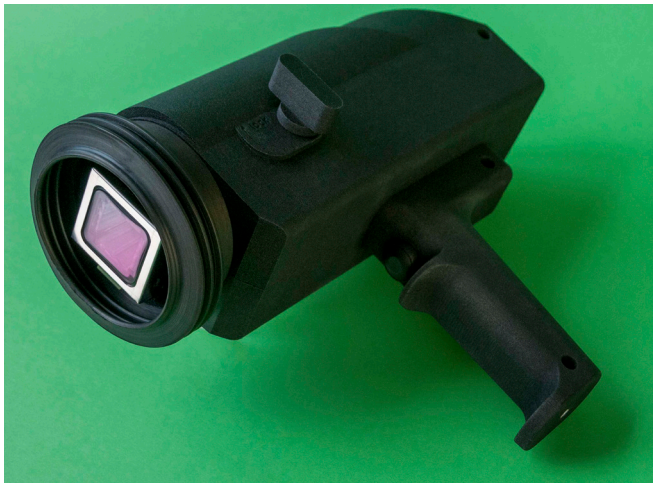
Demonstrator einer mobilen Messpistole mit lumineszenter Trägerfolie. © Fraunhofer IST, Falko Oldenburg
