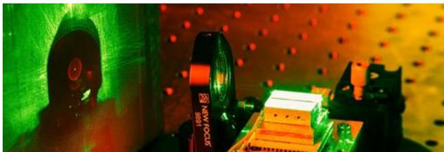
**Quelle einzelner verschränkter Photonen durch parametrische Fluoreszenz in einem nichtlinearen Kristall (©Fraunhofer IPM)**
