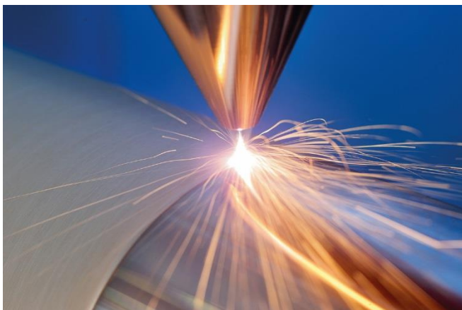
Bild 1: Den Prozess im Griff: Für anspruchsvolle additive Laserverfahren wie das Extreme Hochgeschwindigkeits-Laserauftragschweißen EHLA entstand am Fraunhofer ILT ein Inline-Messsystem. © Fraunhofer ILT, Aachen.
